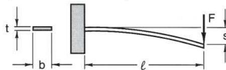
*Dans notre cas  $t$  et  $b$  représenteraient le diamètre,  $D$ , du fil. Ainsi la raideur, proportionnelle à  $bt^3$  seraient bien proportionnelle à  $D^4$ . Le seul hic, c'est que ce coefficient de raideur est aussi fonction de la longueur. Cela n'apparaît pas dans la relation donnée par Monsieur Pelletier. Si quelqu'un a des infos...je suis preneur.*
